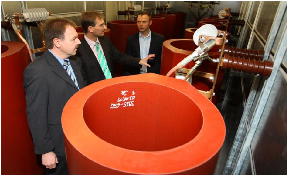
Bild 9: FRT-Prüfcontainer zur Untersuchung des Verhaltens von Erzeugungsanlagen bei Netzfehlern
